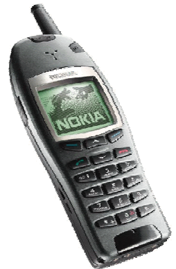
NOKIA THR850, WAP- fähiges TETRA-Gerät. Bauform, Zubehör und Bedienung entsprechen den Nokia Handys,
