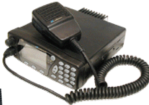
Fahrzeugfunkgerät Teltronic MDT400 Dual-Mode: TETRA und GSM, eingebauter GPS-Empfänger
